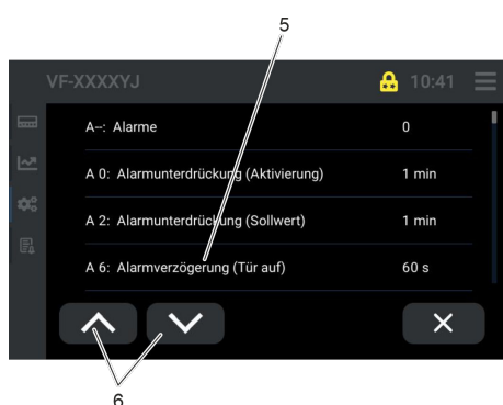
Fig. 87: Message d'alarme A6
